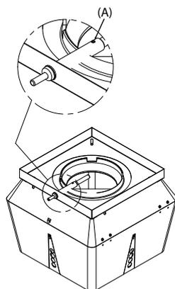
Wenn ein FRx-AFD-Abdeckung verwendet wird, entfernen Sie den Stopfen vom Rohr und setzen Sie den Sensor ein. Ziehen Sie die Schraube (A) fest.
