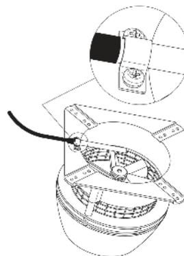
Wenn ein FRx-AFD-Abdeckung verwendet wird, entfernen Sie den Stopfen vom Rohr und setzen Sie den Sensor ein. Ziehen Sie die Schraube (A) fest
