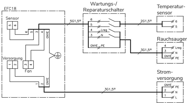
Schließen Sie den EFC18 und den Temperatursensor wie im folgenden Diagramm an (RSHT)
