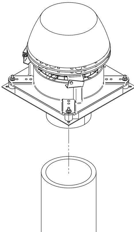
Verwenden Sie den Sicherheitsdraht, um den Ventilator am Schornstein zu befestigen. Bringen Sie die mitgelieferte selbstschneidende Schraube im Stahlschornstein an. Montieren Sie dann den Draht durch das vorgesehene Loch in der Grundplatte und in die Drahtsicherung.
