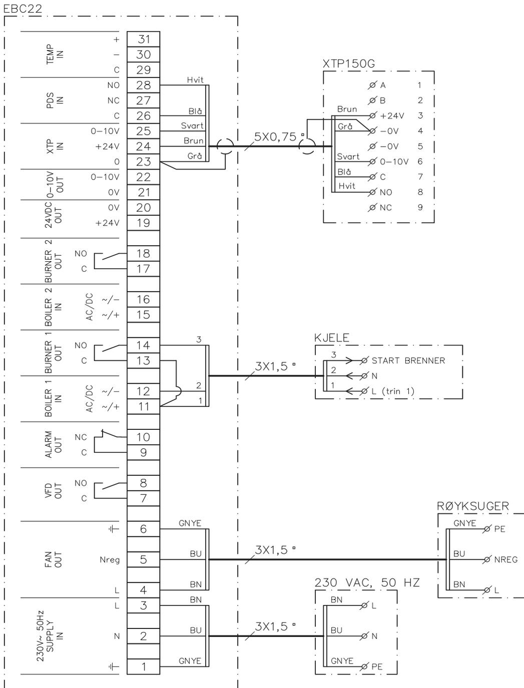
Eksempelet viser hvordan et spenningssignal (10-230 V AC/DC) forbindes til EBC22 for å starte/stoppe røyksugeren fra en enkelt eller to uavhengige kjeler:
