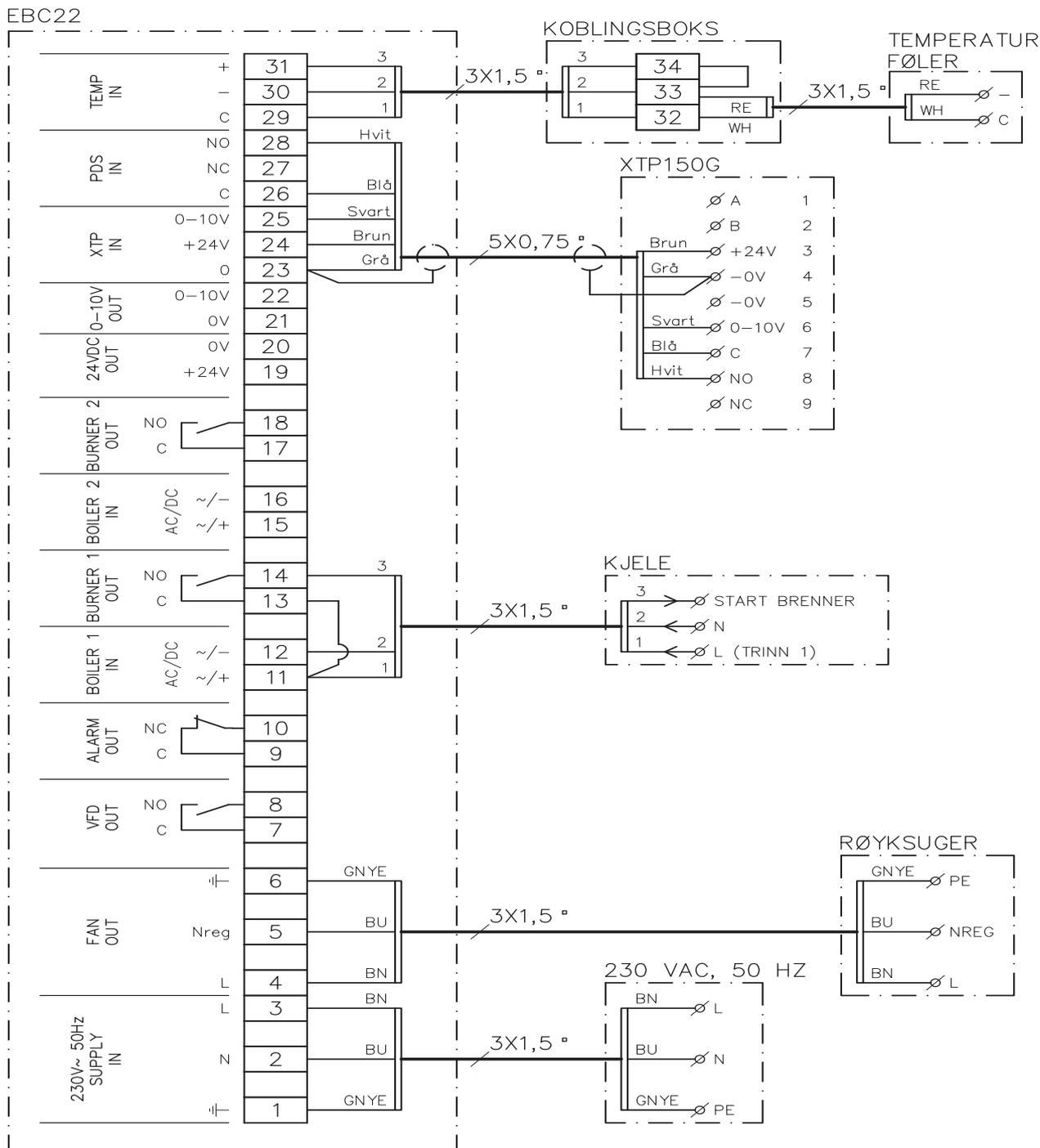
Eksempelet viser hvordan en temperaturføler for start og stopp av røyksugeren kobles til EBC22.
