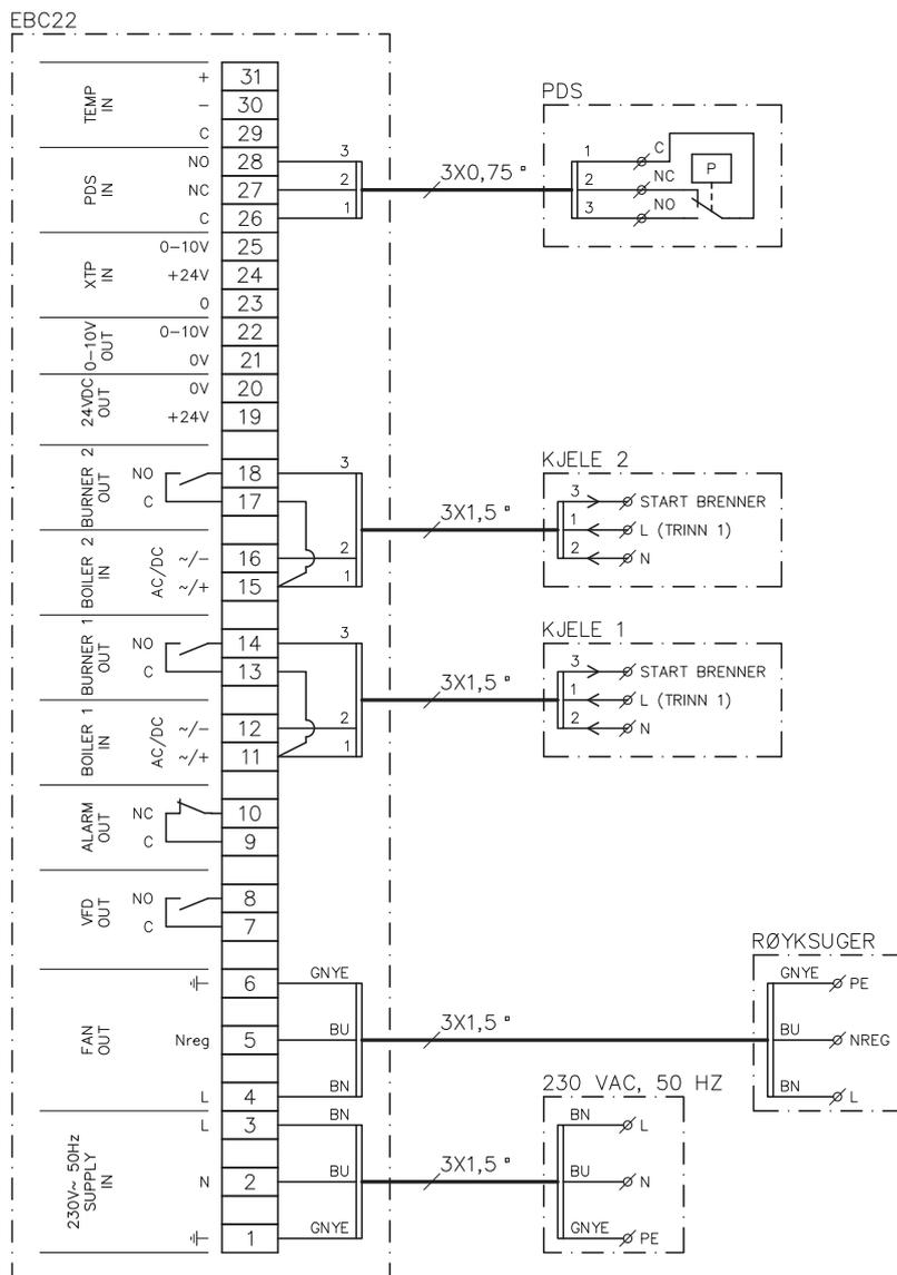
Eksempelet viser hvilke inn-/utganger på EBC22 som skal forbindes til to ett-trinns kjeler. Kjele-utgangen for trinn 1 er et spenningssignal.
