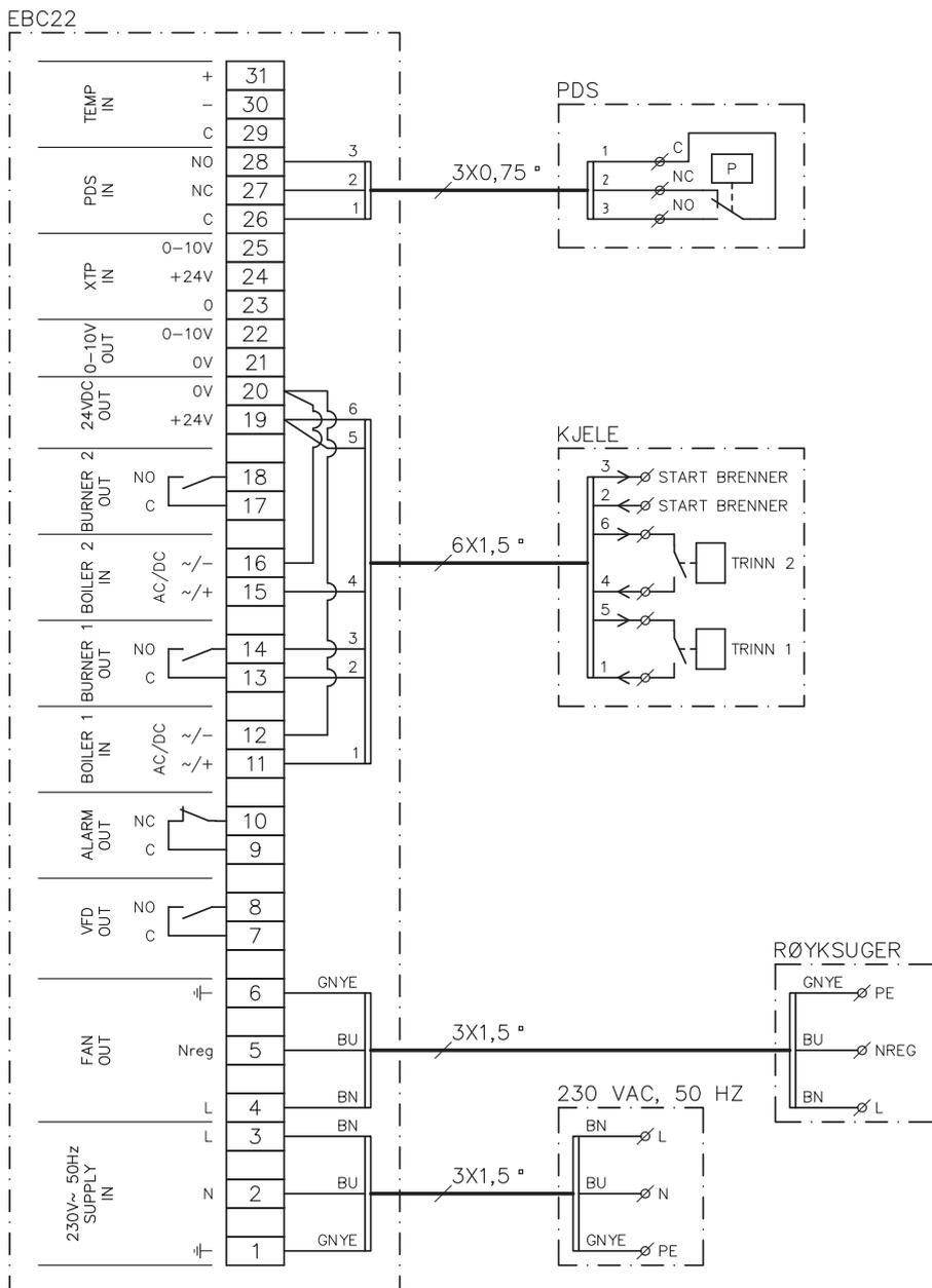
Eksempelet viser hvilke inn-/utganger på EBC22 som skal forbindes til en to-trinns kjele: Kjele-utgang for trinn 1 og 2 er to potensialfrie kontaktsett.
